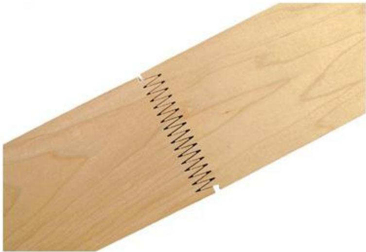
指接好的木条，侧面涂胶，冷压后，锯成标准规格的整张指接板。
