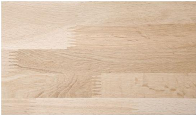
上面这种是明齿，你能看到木条指接的面。还有一种是暗齿，指接面在木条的侧面。
